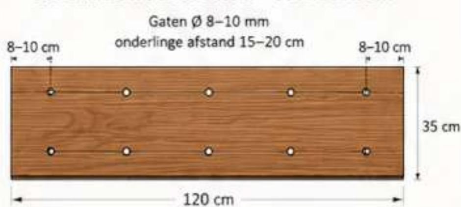
BODEMPLAAT PLANTENBAK – BOVENAANZICHT
