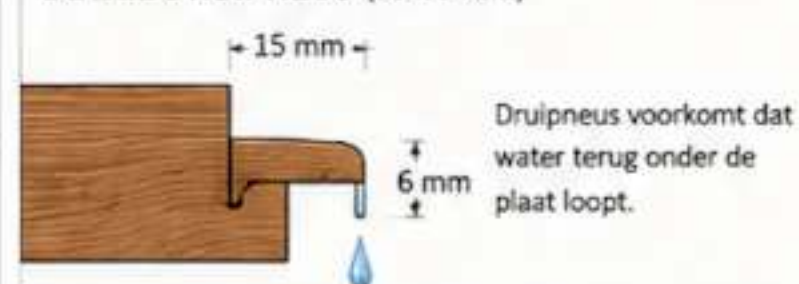
DETAIL DRUIPNEUS (schaal 2:1)
